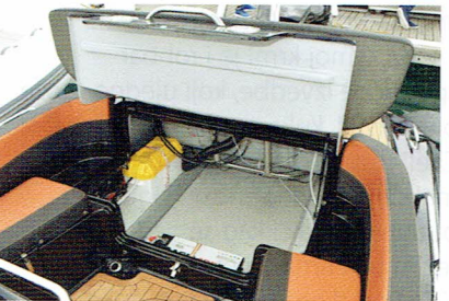
Ispod središnje klupe je veliki prostor u kojem je sva električna oprema, filtri, akumulatori...
