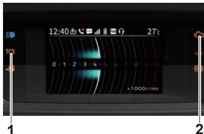
1. Kontrollleuchte für das Traktionskontrollsystem "TCS"
