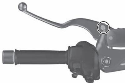
Die Hebeldrehpunkte der Vorderrad- und Hinterrad-Bremshebel sollten in den empfohlenen Abständen gemäß Wartungs- und Schmiertabelle geschmiert werden.
