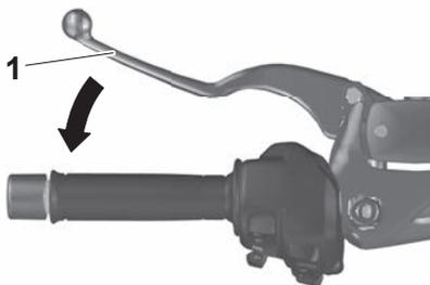
1. Handbremshebel (Hinterradbremse)
