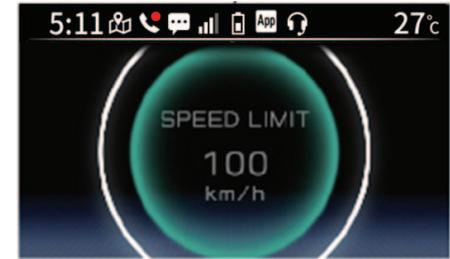
Die Geschwindigkeitsbegrenzung auf der gerade befahrenen Straße wird mit Text und durch den äußeren Kreis angezeigt. Der innere Kreis vergrößert/verkleinert sich, um die aktuelle Fahrzeuggeschwindigkeit anzuzeigen. Wenn die Geschwindigkeitsbegrenzung erreicht/überschritten wird, wechselt die Farbe des äußeren Kreises zu Orange.
