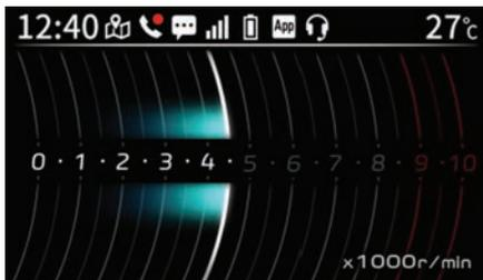
Der Drehzahlmesser-Visualizer zeigt die Drehzahl des Motors, gemessen an der Kurbelwelle, in Umdrehungen pro Minute (U/min).
